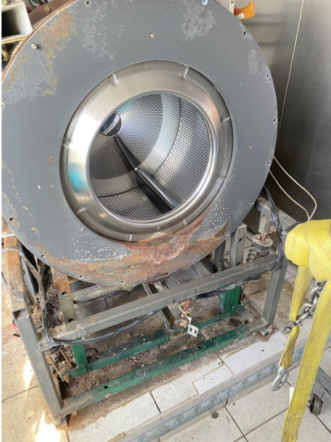
Daño por corrosión
